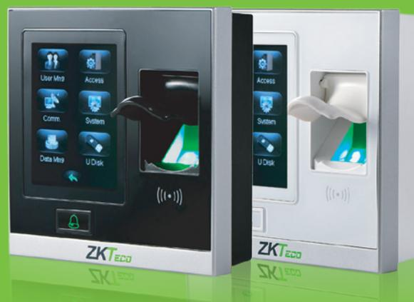
El SF400 es una terminal IP de huella digital, que opera de modo independiente. Se puede conectar con el software ZKAccess3.5 para control de acceso y gestión de tiempo y asistencia.
